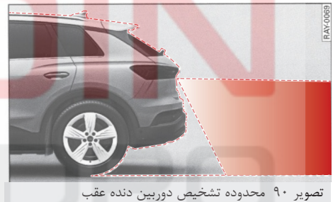
تصویر ۹۰ محدوده تشخیص دوربین دنده عقب
